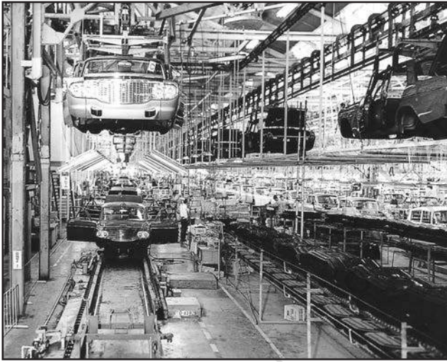
شکل 6.4 : جاپان میں موٹر کمپنی کے ایک کارخانے میں اسمبلی لائن پر مسافر کاروں کا بنانا
