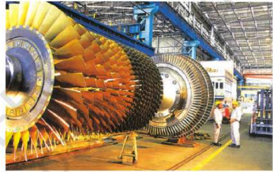
شکل 6.10: بی ایچ ایل حیدر آباد میں گیس ٹربائن کاروٹر کل ہرزے لگانے کے مقام پر
