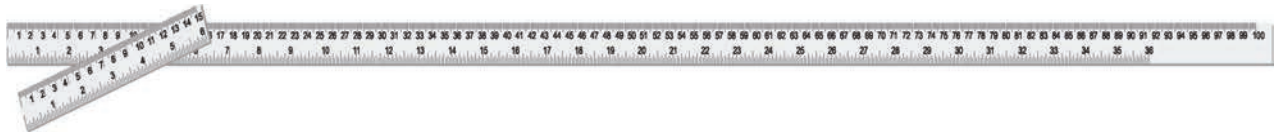
شکل 10.6 ایک میٹر کا پیمانہ اور 15cm کا پیمانہ
