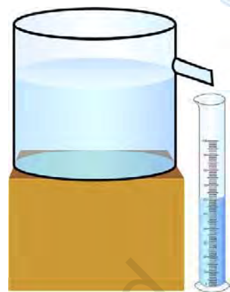
चित्र 37.1 (a) : आप्लावी बर्तन एवं मापक सिलिंडर का समायोजन
