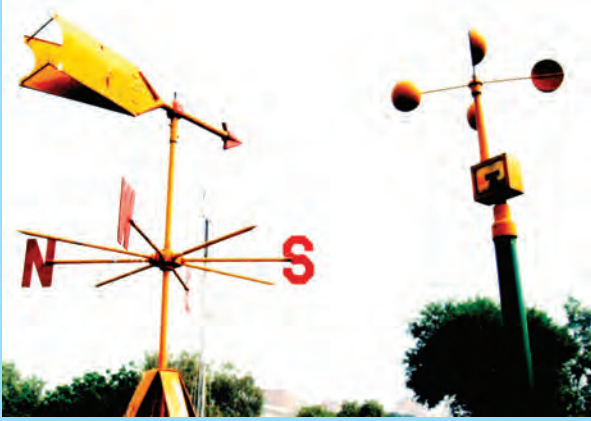
चित्र 8.17 पवन के वेग को मापने के लिए एक वायुमापी आभार- भारत मौसम विज्ञान विभाग, नई दिल्ली
