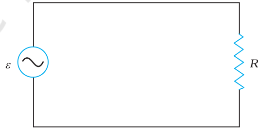
شکل 7.1 ایک مزاحمہ پر لگائی گئی AC وولٹیج
