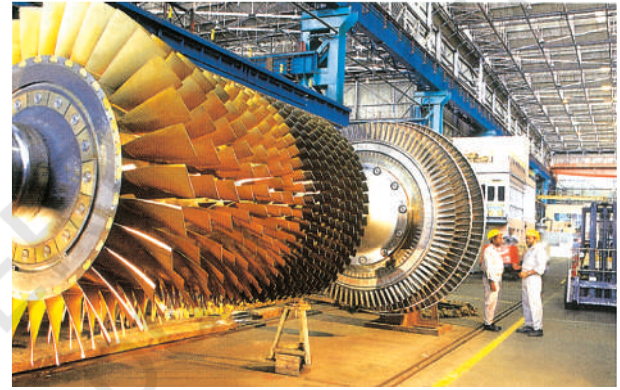
شکل 6.10: بی ایچ ایل حیدر آباد میں گیس ٹربائن کاروٹر کل پرزے لگانے کے مقام پر
