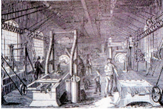
شکل 6۔ انگلستان میں ایک فٹنگ شاپ۔ دی السٹریٹڈ لندن نیوز، 1849۔ اس فٹنگ شاپ میں نئے ریلوے انجن بننے تھے اور پرانے انجنوں کی مرمت ہوتی تھی۔
