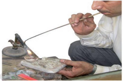
شکل 6.14 : دھاتی پھونکنی سے پھونکتا ہوا سنار
