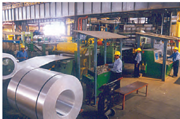
चित्र 6.6 – नाल्को प्रगलक में पट्टी लेप मिल
