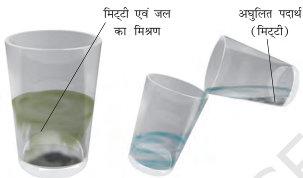
चित्र 5.8 किसी मिश्रण के दो अवयवों को अवसादन तथा निस्तारण द्वारा पृथक करना
