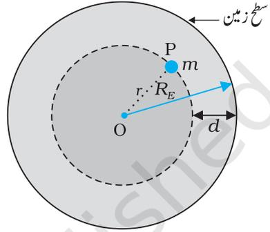
شکل 8.7 کمیت  $m$  کسی کان میں زمین (کمیت  $M_E$  اور نصف قطر  $R_E$ ) کسی سطح سے  $d$  گہرائی پر واقع ہے۔ زمین کو ہم کروی طور پر متشاکل (Spherically symmetric) مانتے ہیں۔
