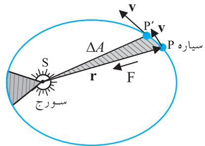
شکل 8.2 سیارہ P سورج کے گرد ناقص مدار میں حرکت کرتا
