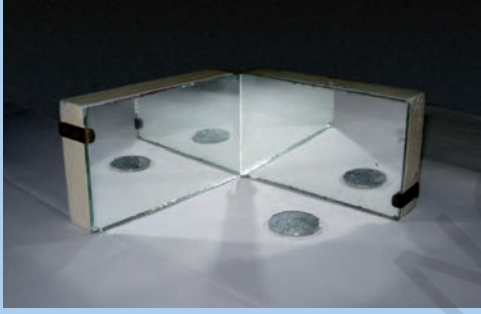
شکل 16.10 : زاویہ قائمہ پر رکھے ہوئے مسطح آئینوں میں شبیہیں دیکھیے اب موم بتی کی کتنی شبیہیں نظر آتی ہیں (شکل 16.11)۔
